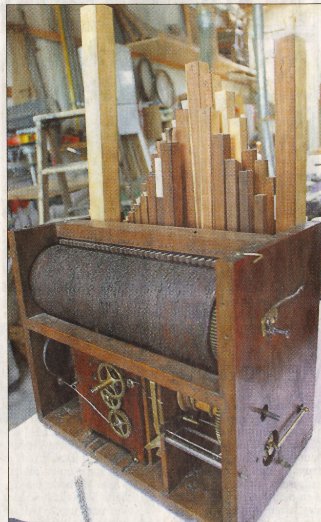
Stolze neun Kilo wiegt der Bleuzylinder, der Walze und Blasebalg antreibt.
